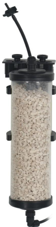
Der Aqua Medic **Hydrocarbonatreactor HR 400** ist ein anschlussfertiger Filter, der hinter einen Schwefelnitratfilter montiert wird, um die entstandene Schwefelsäure zu neutralisieren. Er kann auch hinter einen Kalkreaktor geschaltet werden, um überschüssiges CO<sub>2</sub> abzufangen.
